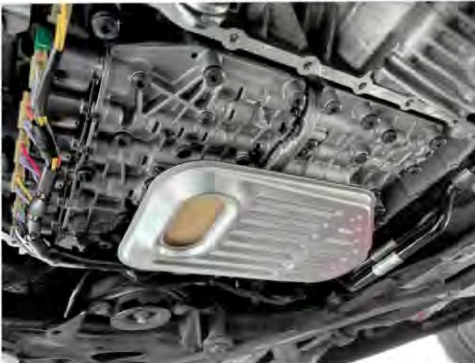
Sensibles Bauteil: die Mechatronik, hier bereits mit Getriebegehäuse-Innenreiniger gesäubert und mit neuem Ölfilter bestückt
