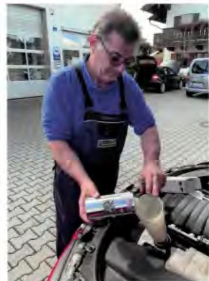
Zum Komplettservice gehört für Gerhard Heimerer auch ein Motorölwechsel mit Vorabspülung und einem abschließenden Cera Tec-Zusatz zur Optimierung von Leistung und längerer Lebensdauer des Motors.
