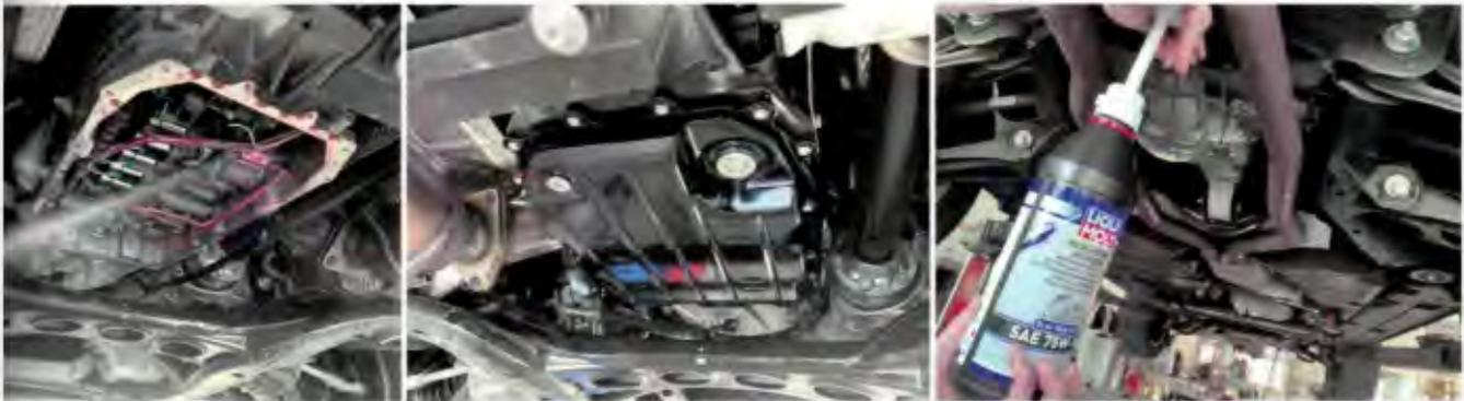
Auch beim 8-Zylinder-SUV wurde die Mechatronik zusätzlich mit einem Reiniger behandelt, danach die Ölwanne montiert und zusätzlich das Öl der Achsdifferentiale gewechselt.
