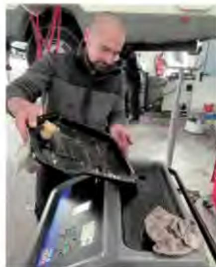
Markus Scherl ist das „Gehirn“ der LM Gear Tronic I und II. Restöl der Getriebewanne leert er direkt in den integrierten Altölbehälter. Danach werden Wanne und Magnetplättchen von Metall-Abrieb befreit.
