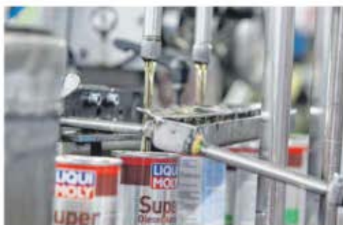
Abfüllvorgang eines öl-basierten Additivs: Zwischen 15 und 16 Millionen Dosen füllt Liqui Moly jedes Jahr in Ulm ab. FOTO: BENJAMIN WÄGNER
