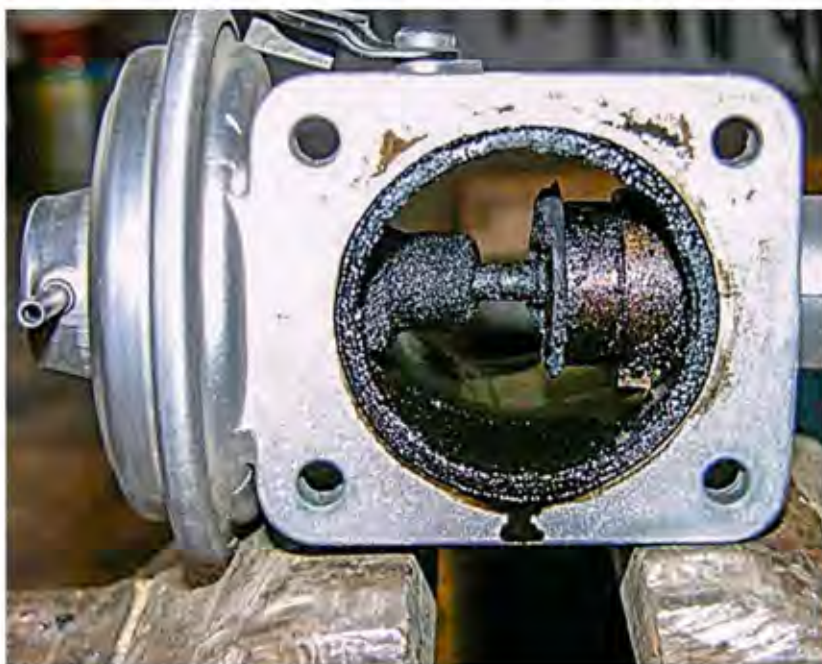
▲ Verkokungen und Rückstände an Ventilen, Kolben und Co sollen durch Additive vermindert werden. Das kann die Lebensdauer steigern
