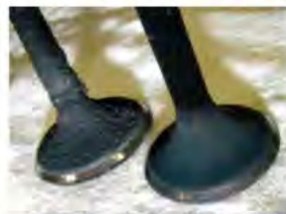
▲ Verkokungen und Rückstände an Ventilen, Kolben und Co sollen durch Additive vermindert werden. Das kann die Lebensdauer steigern
