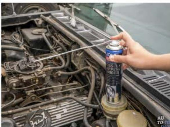
Согласно инструкции, мы сняли воздушный фильтр с карбюратора, и распылили средство через специальную трубку-удлинитель, на конце которой установлена распределяющая поток форсунка. Мы обработали средством детали, которые нуждаются в очистке, и впускной коллектор. Затем дали средству подействовать в течение 5 минут. Следующий обязательный пункт – завести двигатель, дать поработать 10-15 минут и продолжить очистку на работающем двигателе.
