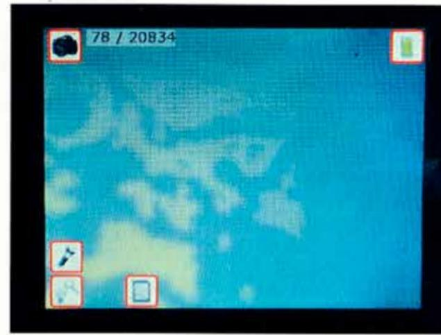
Wie es im Inneren des Tanks aussieht, kann z.B. ein Tankreiniger mit einer Kamerauntersuchung sichtbar machen. Hier sind deutliche „Dieselpest“-Ablagerungen am Tankboden erkennbar.
