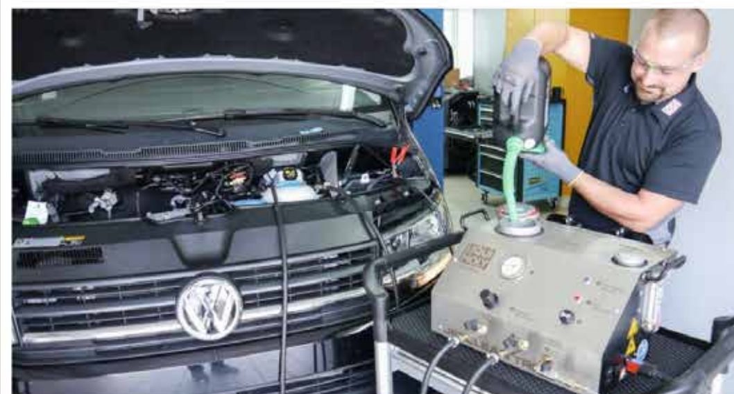
Ablagerungen an Injektoren, Düsen und im Ansaugtrakt führen zu Fahrverhaltensmängeln und erhöhen den Kraftstoffverbrauch. Prophylaktisches Abreinen ist mit dem JetClean Tronic II von Liqui Moly ebenso möglich wie eine „problembezogene Intensivreinigung“. Bild: Kuss
