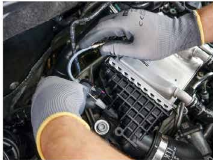
Über die Bohrung des Drucksensors gelangt die Reinigungsflüssigkeit auf kürzestem Wege in den Ansaugtrakt, um AGR-Ventil, Einlassventile und die gesamte Ansaugstrecke von störenden Öl- und Rußablagerungen zu befreien. Bild: Kuss
