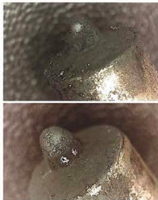
Eine derart verkockte Injektorspitze vereitelt eine saubere Einspritzung und führt zu einer schlechten Gemischbildung (oben). Nach der Intensivreinigung mit dem ‚JetClean Tronic II‘ sind die störenden Rückstände verschwunden. Bilder: Liqui Moly
