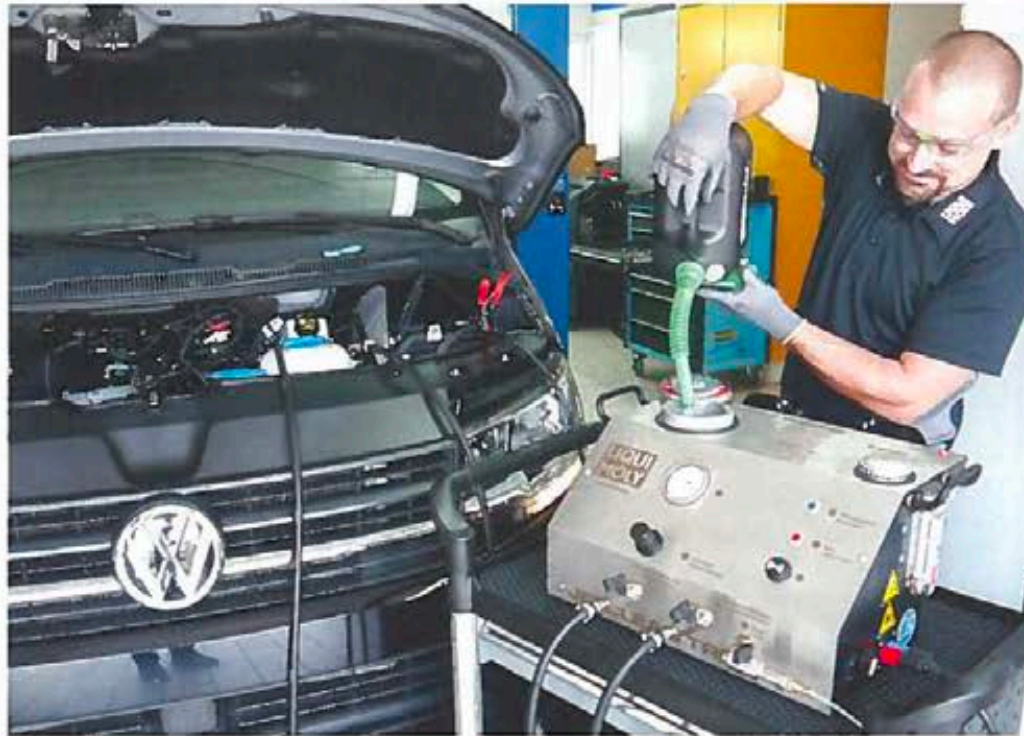
Ablagerungen an Injektoren, Düsen und im Ansaugtrakt führen zu Fahrverhaltensmängeln und erhöhen den Kraftstoffverbrauch. Prophylaktisches Abreinigen ist mit dem „JetClean Tronic II“ von Liqui Moly ebenso möglich wie eine „problembezogene Intensivreinigung“. Bilder: Kuss
