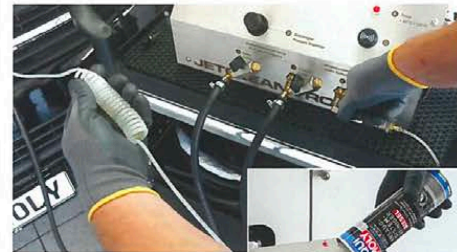
Bei Selbstzündern gelangt der Reiniger per Überdruck in den Ansaugbereich. Die durchsichtige Wendel hilft beim Dosieren. Der ‚Pro-Line‘-Ansaugsystemreiniger ist gebrauchsfertig vorgemischt (kl. Bild).
