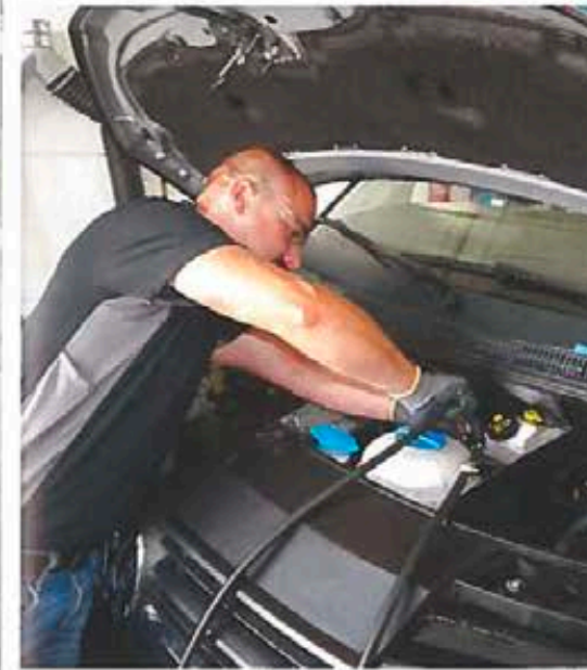
Der Einspritzsystemreiniger gelangt direkt über den Vorlauf der Hochdruckpumpe zu den Injektoren. Der fahrzeugseitige Rücklauf ist dabei überbrückt. Fahrzeugspezifische Adapter gibt es als Zubehör, um ein professionelles Arbeiten mit dichten Verbindungen sicherzustellen.
