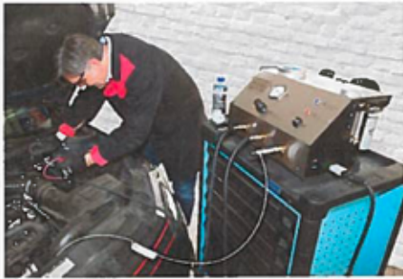
Das JetClean Tronic II entfernt Ablagerungen im Motor und Kraftstoffsystem schnell und gründlich
