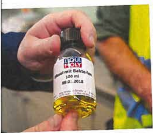
Moderner Dieseldieselkraftstoff wird bei langer Lagerung durch Bakterienkulturen verunreinigt. Additive verhindern den Prozess
