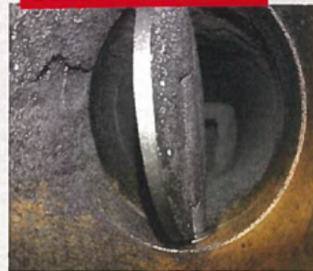
Vorher: Durch Verkokung verursachte Ablagerungen führen zu unrundem Motorlauf, kosten Leistung und erhöhen den Verbrauch
