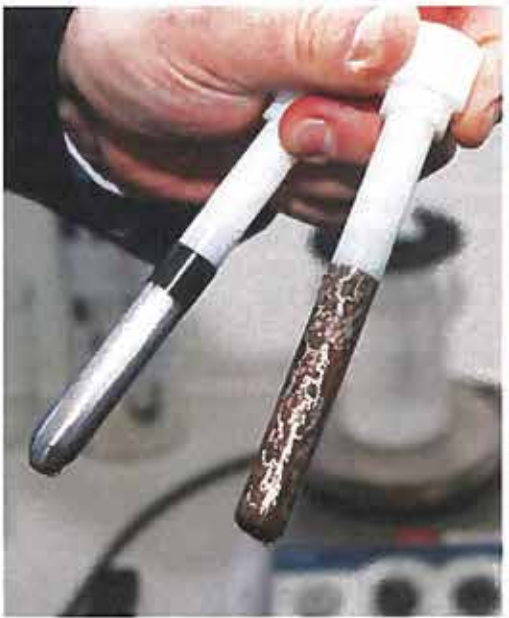
Anti-Korrosions-Additive (hier links) haben verhindert, dass im Motoröl gelöstes Wasser zu Rost im Motor führt
