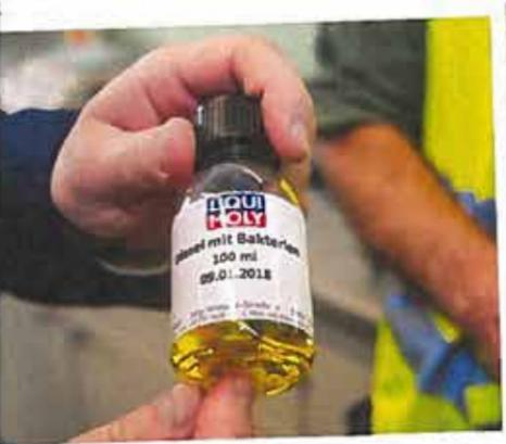
Moderner Dieselmotorkraftstoff wird bei langer Lagerung durch Bakterienkulturen verunreinigt. Additive verhindern den Prozess
