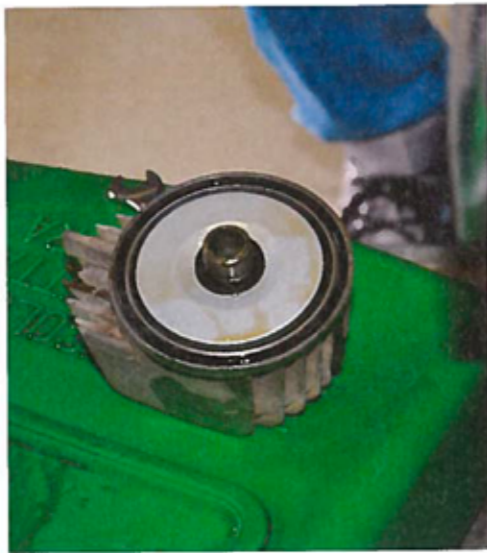
So sahen Ölfilter anno 1979 aus. Eine Nut hilft dabei, den Filter wieder korrekt einzusetzen.
