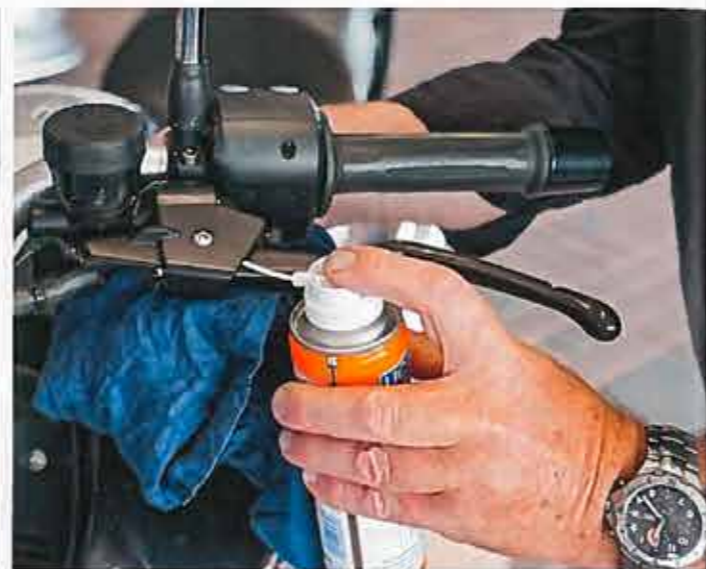
Spezielle Schmiermittel sind den gerne benutzten Vielzweckölen meist überlegen. Das „Wartungsspray Weiß“ von Liqui Moly enthält keramische Bestandteile und haftet bestens
