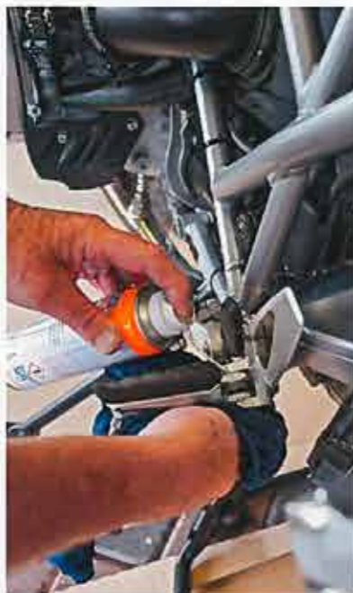
Spezielle Schmiermittel sind den gerne benutzten Vielzweckölen meist überlegen. Das „Wartungsspray Weiß“ von Liqui Moly enthält keramische Bestandteile und haftet bestens
