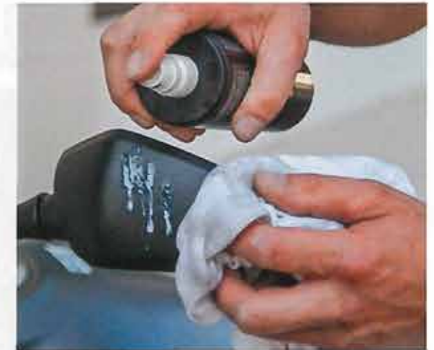
UV-Strahlen und Hitze entziehen dem Kunststoff seine Weichmacher und lassen das Material spröde und später rissig werden. Kunststoffpfleger dringen in die Oberfläche ein und frisieren sie auf. Silikonfett am Kerzenstecker vollbringt wahre Wunder
