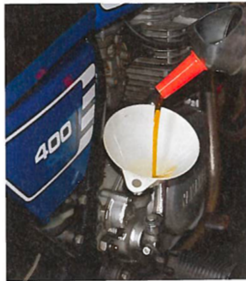
Sitzen neuer Ölfilter und Ölablass-Schraube wieder fest, frisches Öl nach Herstellervorgabe auffüllen.
