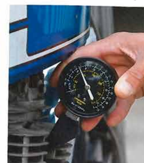
Die Kompression auf dem rechten Zylinder beträgt anfangs 6,7 bar – zudem ist die Abweichung hoch.
