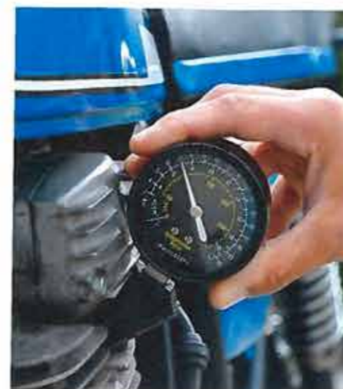
Vor der Anwendung des Motor-Innenreinigers liegt die Kompression des linken Zylinders bei 7,2 bar.
