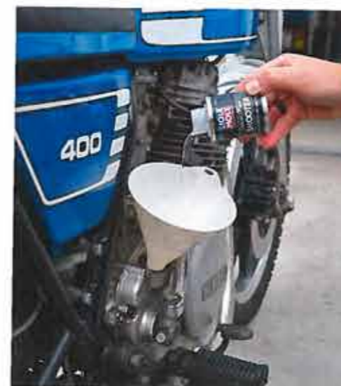
»Engine Flush« wird dem warmen Motoröl beigegeben – anschließend zehn Minuten Standlauf.
