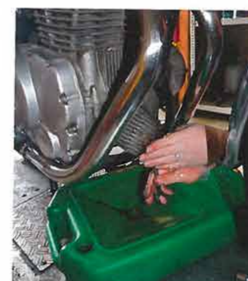
Auch der Ölfilter sollte erneuert werden. Vor dem Einsetzen ist die Dichtung mit Öl zu benetzen.
