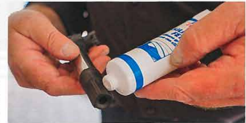
UV-Strahlen und Hitze entziehen dem Kunststoff seine Weichmacher und lassen das Material spröde und später rissig werden. Kunststoffpfleger dringen in die Oberfläche ein und frisieren sie auf. Silikonfett am Kerzenstecker vollbringt wahre Wunder
