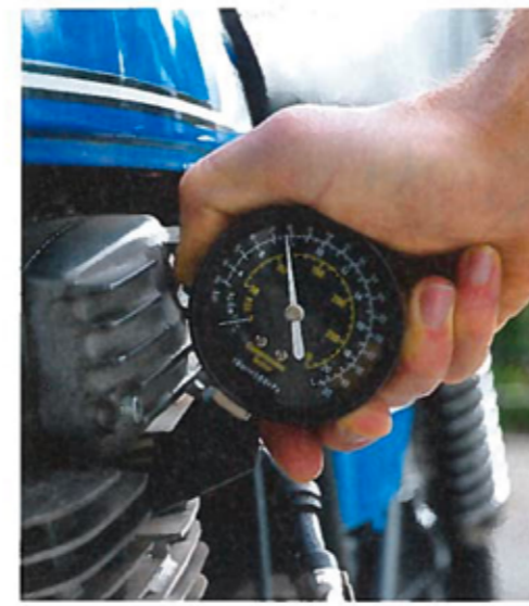
Knapp 8 bar lautet der Kompressionswert am linken Zylinder nach der Motorreinigung.
