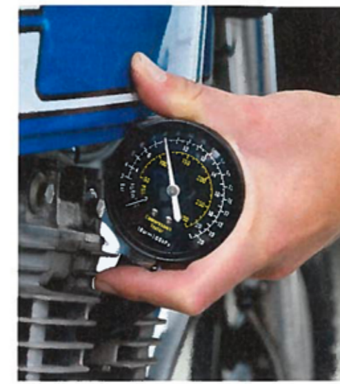
Auch der rechte Zylinder drückt 8 bar. Nun liegt der Wert etwa gleichauf mit dem linken Zylinder.
