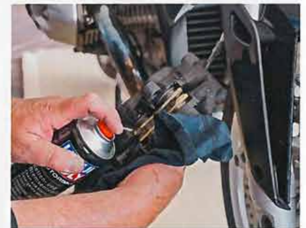
Erst putzen und dann verwöhnen. Bremsflüssigkeit „zieht“ Wasser. Das sammelt sich am Boden der Anlage, sprich am unteren Kolben. Der korrodiert und reagiert verzögert. Rost lösen mit Bremsenreiniger und Silikon spray als Gleitmittel aufbringen, das macht ihn flott
