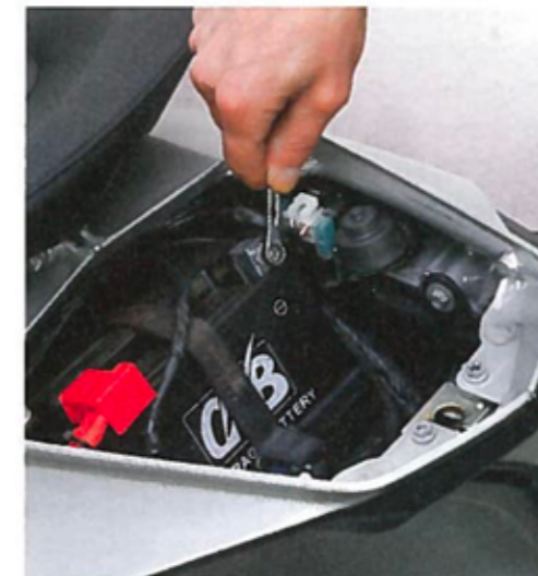
Vor dem Winterschlaf sollte man die Batteriepole reinigen. Dabei zuerst den Minuspol abklemmen.
