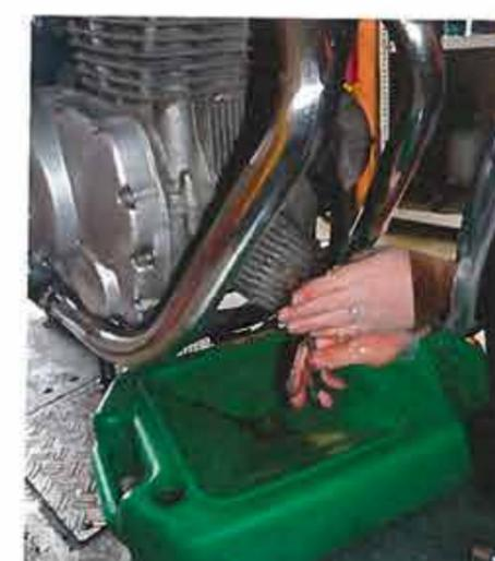
Auch der Ölfilter sollte erneuert werden. Vor dem Einsetzen ist die Dichtung mit Öl zu benetzen.
