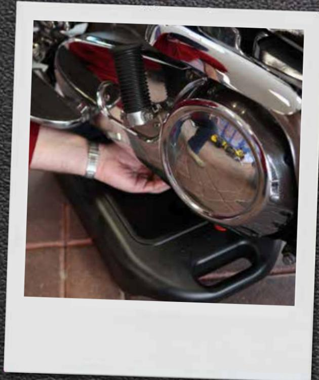
Altöl nach ca. 10 Minuten Leerlauf vollständig ablassen, um anschließend Öl- und Filterwechsel durchzuführen.
