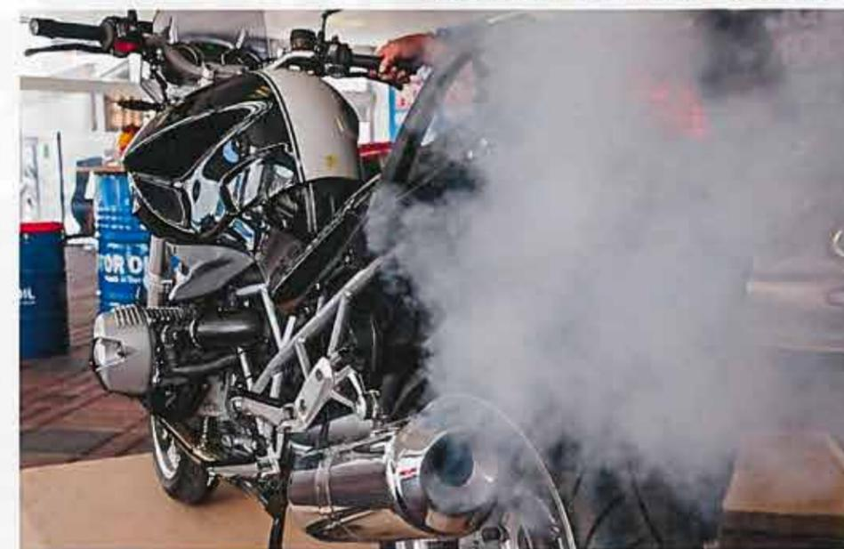
Vor dem Ölwechsel mit „Engine Flush“ durchputzen. Löst Rückstände, bindet diese und hält sie bis zum nächsten Wechsel in Schwebelose. Beim Einfüllen des neuen Öls „Oil Additive“ hinzu und ins Kerzenloch „Motor-Innenkonservierer“. Motor mehrmals durchdrehen – gut gerüstet für drei Jahre Standzeit
