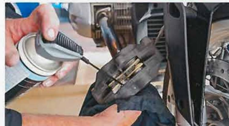
Erst putzen und dann verwöhnen. Bremsflüssigkeit „zieht“ Wasser. Das sammelt sich am Boden der Anlage, sprich am unteren Kolben. Der korrodiert und reagiert verzögert. Rost lösen mit Bremsenreiniger und Silikon spray als Gleitmittel aufbringen, das macht ihn flott
