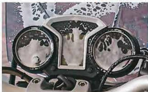
Komplettreiniger wie etwa der Motorbike Cleaner von Liqui Moly können an allen Stellen der Maschine benutzt werden – Anwendungshinweise beachten und nicht auf heiße Flächen sprühen. Für Scheibe und Cockpit nimmt man am besten den Scheibenreinigerschaum, der recht gut haftet und die Fliegenreste löst
