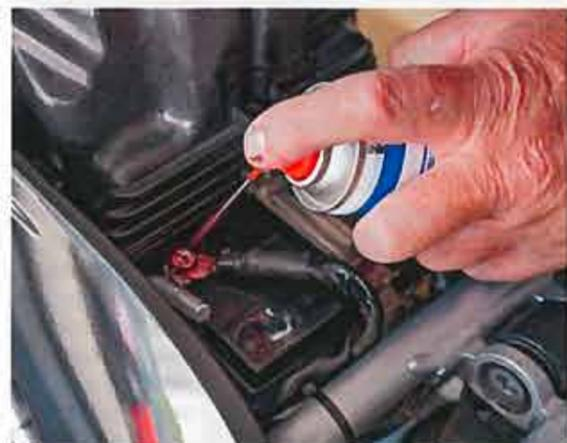
Oft steckt der Teufel im Detail. Korrodierte Kontakte von Leuchtmitteln schleift man blank. Andere Verbindungen lassen sich schwer von feinem Rostschleier befreien. Hier hilft Elektronikspray. Polfett an den Anschlüssen der Batterie ist völlig aus der Mode – die Akkuhersteller freut's. Steckdosen und Schösser haben auch ein Innenleben, das Zuwendung braucht
