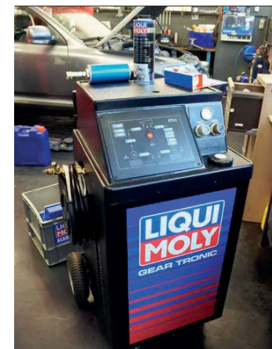
Demonstration von «Gear Tronic» in der markenfreien Garage HP Rohr AG in Glattbrugg ZH: Das Gerät von Liqui Moly füllt nicht einfach nur neues Öl nach bzw. ersetzt das Altöl im Getriebe, sondern es wird auch gleich zur Reinigung des Getriebes verwendet.
