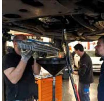
Komplette Beseitigung des Altöls bringt nebst dem Einsatz von «Gear Tronic» auch das Entleeren der Getriebeölschale.
