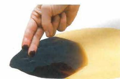
1 Die Öldruck-Kontrolllampe muss beim Einschalten der Zündung aufleuchtet ... 2 ... und muss bei laufendem Motor erlöschen. 3 Der richtige Ölstand kann über einen Peilstab ... 4 ... oder am Schauglas kontrolliert werden. 5 Im Gebrauch ändert sich die goldene Farbe des neuen Öls schnell in dunkelbraun bis schwarz, ein Beweis für seine gute Arbeit.
