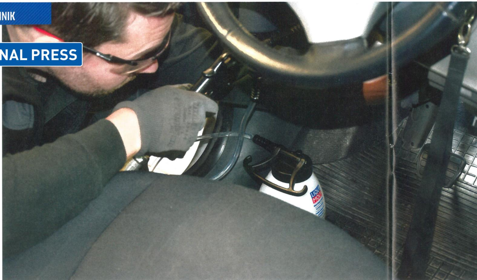
Der Anwender reinigt den Verdampfer mit der Desinfektionsflüssigkeit durch vorsichtiges Hin- und Herbewegen der Sprühlanze.
