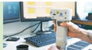
▲ Messwerte sind aussagekräftiger als bloße Inaugenscheinnahme. Die Testbleche wurden mit dem Lichtwertmessgerät gemessen. Je sauberer, desto heller
