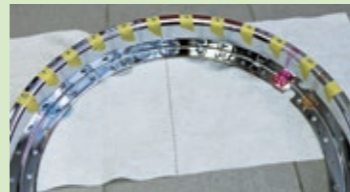
▲ Auf Chrom hinterließ keiner der getesteten Reiniger nach 20 Stunden Einwirkzeit leichte Rückstände. Auch nicht der extrem aggressive Reiniger von Meguiar's
