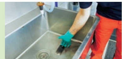
▲ Nach der minimalen auf dem Etikett angegebenen Einwirkzeit werden die Testbleche unter einem Wasserstrahl (Durchflussmenge 100 Liter je Stunde) abgespült und mit Druckluft getrocknet
