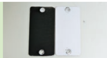
▲ Zwei Tage lang ist der Prüfstand in Betrieb. Die Felge wird stufenweise von 140 auf 50 km/h abgebremst. Dabei entsteht Bremsbelag-Abrieb (links: verschmutzt)
