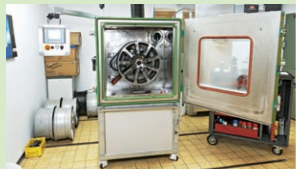
▲ Schmutzerzeuger: Der aufwendige Prüfstand im Sonax-Entwicklungs-Labor sorgt für völlig identischen Bremsbelag-Abrieb auf speziellen Testblechen an der Innenseite einer Felge
