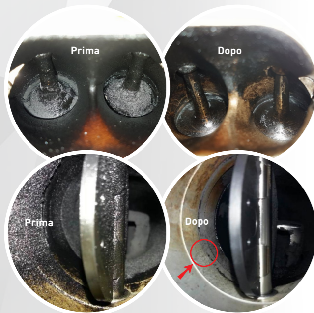
Primo piano delle valvole di immissione (in alto) e della valvola del tubo di aspirazione (in basso).
