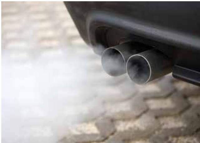
Mögliche Folge verstopfter Dieselpartikelfilter: Feinstaub- und Abgasgrenzwerte können nicht mehr eingehalten werden, was sich negativ auf die Hauptuntersuchung (HU) bzw. Abgasuntersuchung (AU) auswirkt.
