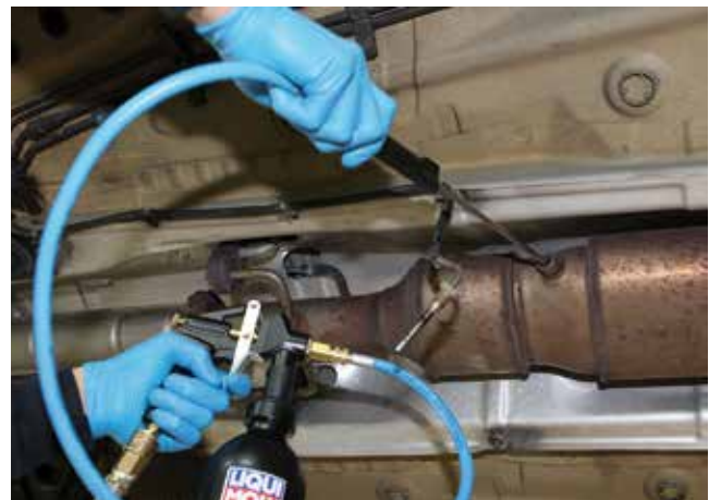
DPF-Service mit Produkten von LIQUI MOLY: Vorteil ist, dass der Partikelfilter eingebaut bleiben kann. Das spart Zeit und Kosten.
