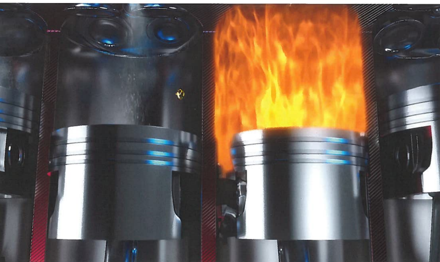
Bei immer höher werdenden Drücken und steigenden Temperaturen der Downsizingmotoren können Öltröpfchen eine Selbstentzündung auslösen. Bilder: Liqui Moly
