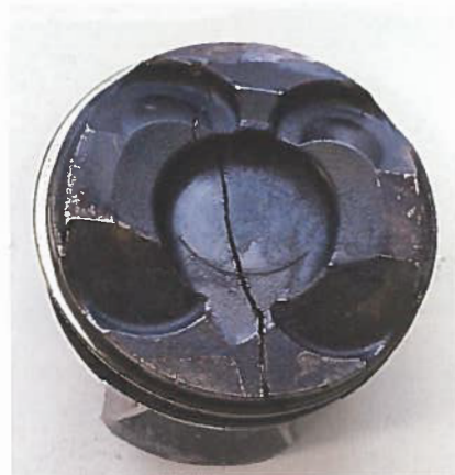
Im Extremfall reißt der komplette Kolbenboden.
