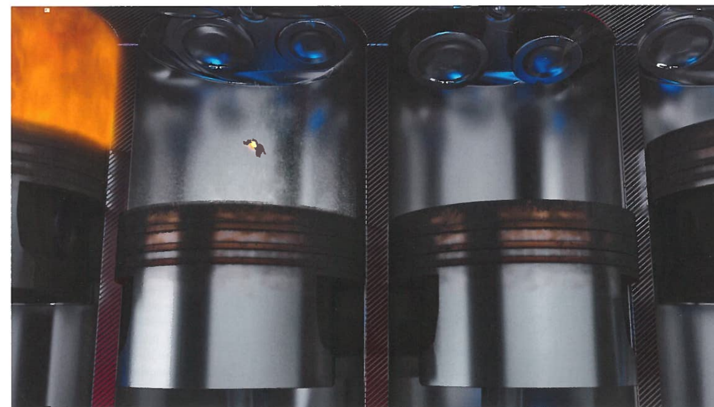
Als zweiten Auslöser von LSPI haben Experten feste Stoffe wie Partikel oder Ablagerungen in Verdacht. Sie sollen im Brennraum bei ausreichender Temperatur eine vorzeitige Zündung verursachen.
