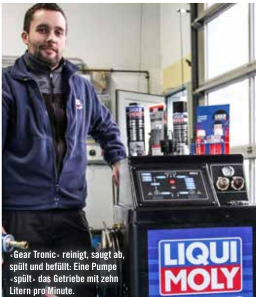
«Gear Tronic» reinigt, saugt ab, spült und befüllt: Eine Pumpe «spült» das Getriebe mit zehn Litern pro Minute.
