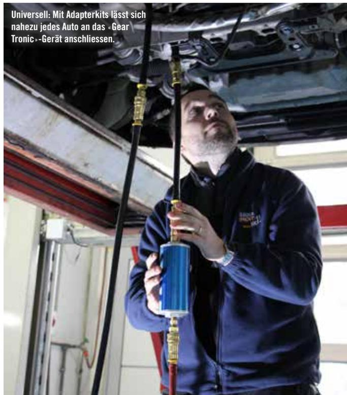
Universell: Mit Adapterkits lässt sich nahezu jedes Auto an das «Gear Tronic»-Gerät anschließen.
