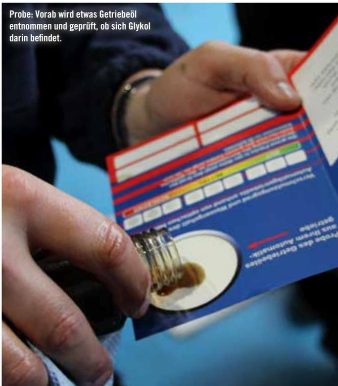
Probe: Vorab wird etwas Getriebeöl entnommen und geprüft, ob sich Glykol darin befindet.
