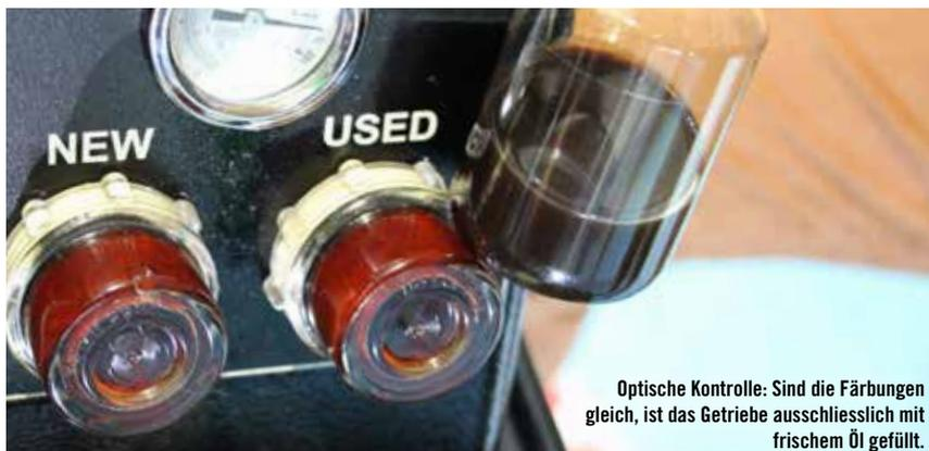
Optische Kontrolle: Sind die Färbungen gleich, ist das Getriebe ausschliesslich mit frischem Öl gefüllt.
