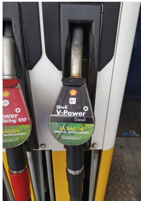
Bei Shells V-Power-Diesel ist der Zusatz „B7“ vermerkt. Bis zu sieben Prozent Biodiesel sind möglich.
