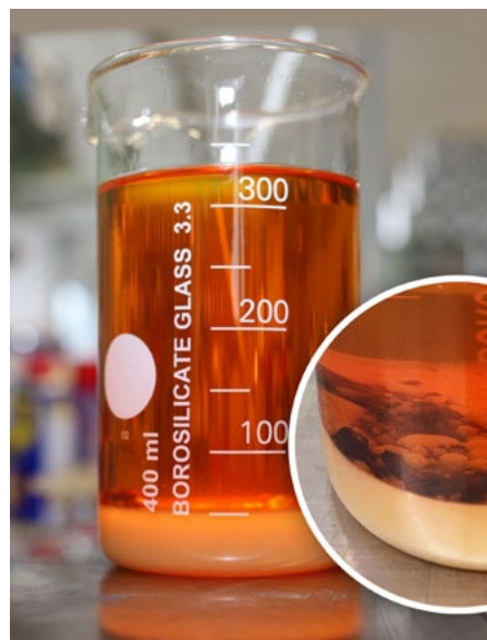
Wenn der Bioanteil im Diesel zu schimmeln beginnt, entsteht eine schlammartige Masse: Dieselpest.
