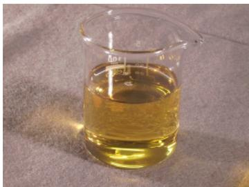
Diese **Grundöle** sind die Basis für Motorenöle. Je nach gewünschten Eigenschaften bildet ein Grundöl oder eine Mischung aus mehreren Grundölen das Fundament – aber mehr eben auch nicht. Sie alleine sind zu leistungsschwach für ein Motorenöl. Würde man einen Motor nur mit Grundöl betreiben, wäre der Motorschaden absehbar. Je nach geforderter Leistung werden nun Additive hinzugefügt. Erst mit ihrer Hilfe entstehen die modernen, leistungsfähigen Motorenöle.
