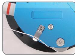
**Nur soviel aufwickeln, wie für die Scheibe benötigt wird! Max. 10 m! Ein paar zusätzliche Wicklungen werden benötigt, damit die Schnur nicht direkt an der Spule reißt.**
