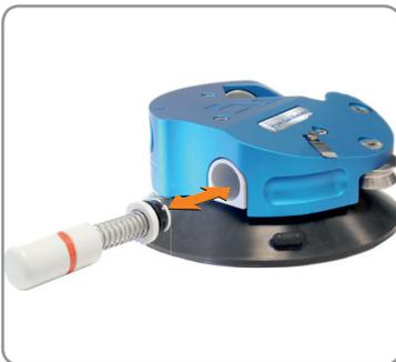
1. Pumpkolben mit rotem Markierungsring aus dem Handgriff ziehen.
