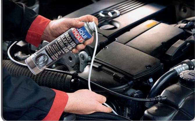
O produto de limpeza para válvulas borboleta elimina os depósitos e os resíduos das válvulas borboleta, dos injectores e de toda a zona de admissão.
