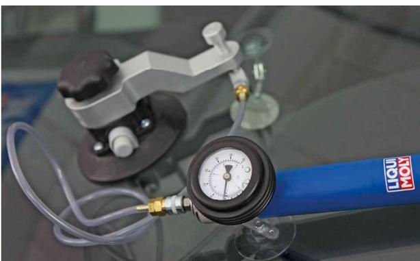
La grande ventosa da 125 mm della base si fissa saldamente con la pompa per vuoto integrata con poche pompate.
