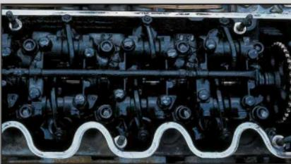
Ölschlamm verstopft Ölkanäle und Bohrungen. Dies führt auf Dauer zu Motorschäden und zu Überhitzung.
