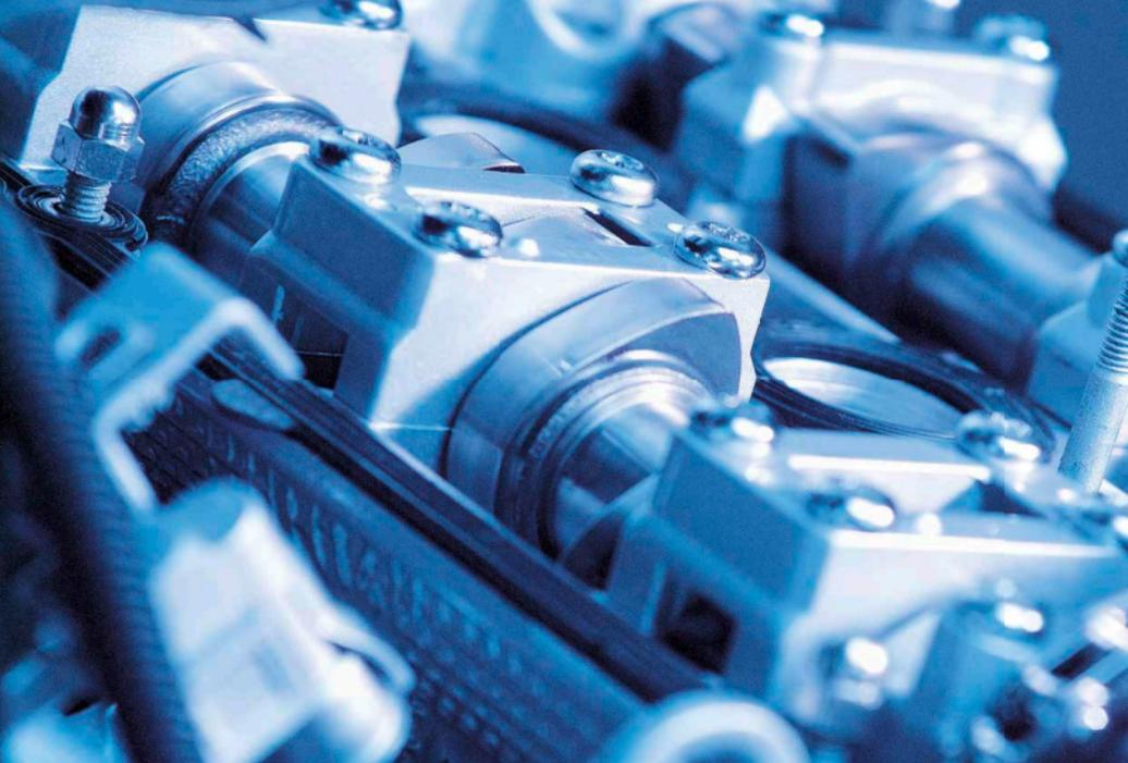
**Motorenöl-Additive werden direkt in die Öleinfüllöffnung des Motors, gegeben und reinigen das System oder reduzieren die Reibung und den Verschleiß.**
