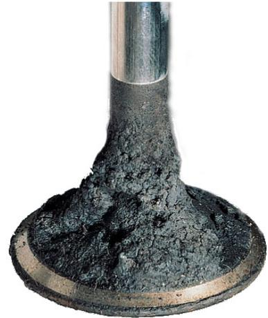
**Besonders betroffen:** Ein- und Auslassventile von Benzinmotoren (Bild oben). Die aufgebauten Verkokungen stören das Ansaugen der Verbrennungsluft und damit die optimale Gemischbildung des Motors. Das führt zu einer schlechteren Leistung, höherem Spritverbrauch und miserablen Abgaswerten.
