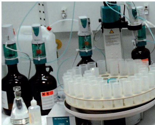
Bestimmung der TBN-Mittels Titrator im Labor
