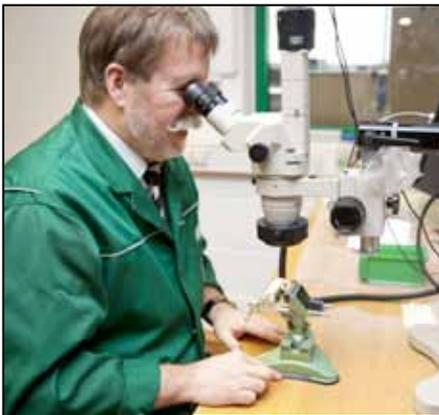
Mikroskopische Untersuchung einer Diesel-Einspritzdüse nach einem Testdurchlauf.
