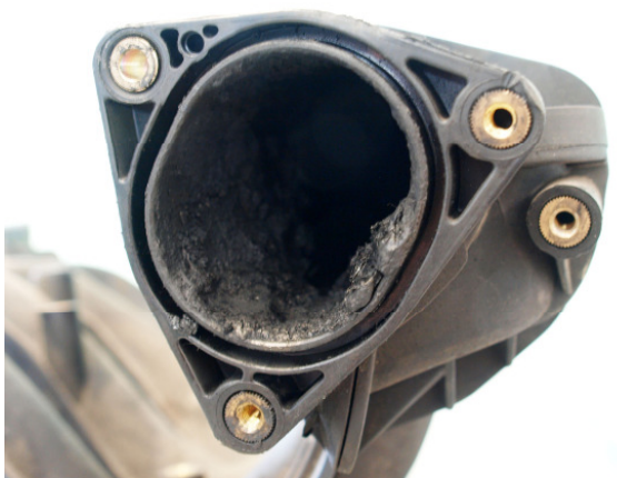
Bild 2: Ansaugbrücke Taxi nach 150.000 km
