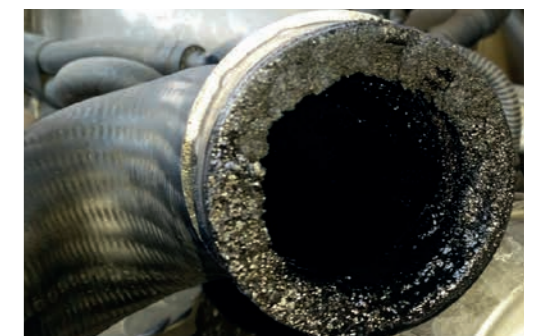
Ein verschmutzter Ansaugbereich
