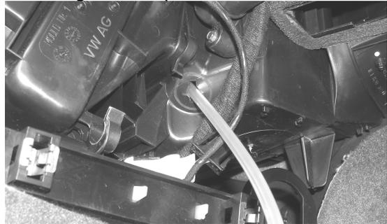
8. Durch Betätigen der Reinigungs-Pistole sowie vorsichtiges hin und her Bewegen der Sprühsonde wird der Verdampfer mit LIQUI MOLY Klima-Anlagen-Reiniger gründlich ausgespült und gereinigt. Achtung: Verdampferoberfläche nicht beschädigen! Zum Schluß je einen Sprühstoß in die Lüftungsdüsen im Innenraum geben.
