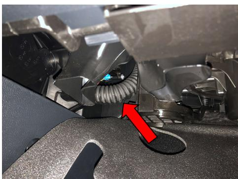
5. Sonde der Reinigungs-Pistole vorsichtig durch die entstandene Öffnung in Richtung Verdampfer einführen. Liqui Moly Klima-Anlagen-Reinigungs-Pistole mit 1 Liter Liqui Moly Klima- Anlagen-Reiniger befüllen und bei 6-8 bar Druck an das Druckluftnetz anschließen.
