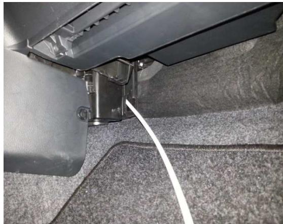
7. Durch Betätigen der Reinigungs-Pistole sowie vorsichtiges hin und her Bewegen der Sprühsonde wird der Verdampfer mit LIQUI MOLY Klima-Anlagen-Reiniger gründlich ausgespült und gereinigt. Zum Schluss je einen Sprühstoß in die Lüftungsdüsen im Innenraum geben.
