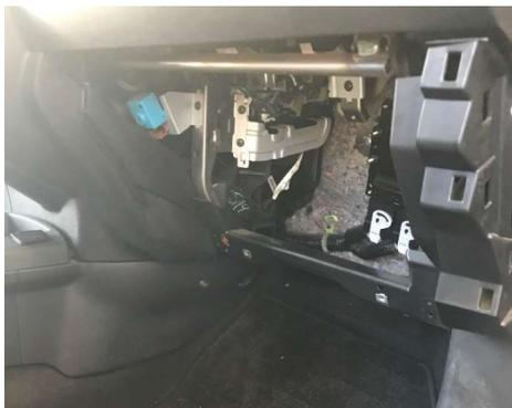
5. Sonde der Reinigungs-Pistole vorsichtig durch die entstandene Öffnung in Richtung Verdampfer einführen.
