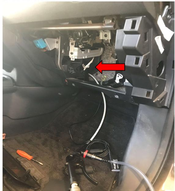
6. Durch Betätigen der Reinigungs-Pistole sowie vorsichtiges hin und her Bewegen der Sprühsonde wird der Verdampfer mit 1 Liter LIQUI MOLY Klima-Anlagen-Reiniger gründlich ausgespült und gereinigt.
