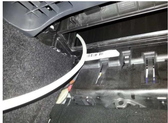
8. Durch Betätigen der Reinigungs-Pistole sowie vorsichtiges hin und her Bewegen der Sprühsonde wird der Verdampfer mit LIQUI MOLY Klima-Anlagen-Reiniger gründlich ausgespült und gereinigt. Zum Schluss je einen Sprühstoß in die Lüftungsdüsen im Innenraum geben.
