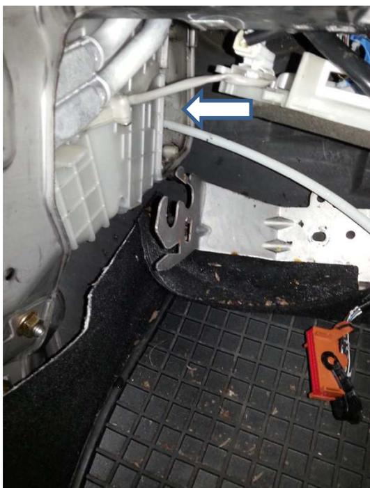
10. Durch Betätigen der Reinigungs-Pistole sowie vorsichtiges hin und her Bewegen der Sprühsonde wird der Verdampfer mit LIQUI MOLY Klima-Anlagen-Reiniger gründlich ausgespült und gereinigt. Zum Schluss je einen Sprühstoß in die Lüftungsdüsen im Innenraum geben.
