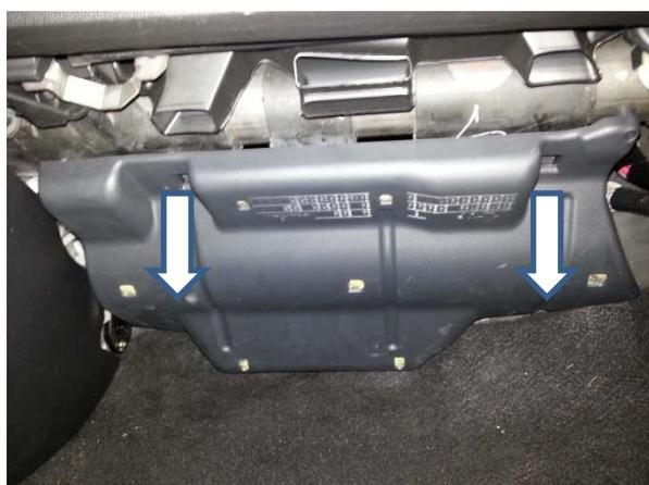
6. Beide Befestigungsmuttern des Halters der Zentralelektronik lösen und entfernen. Anschließend die Halterung abziehen.
