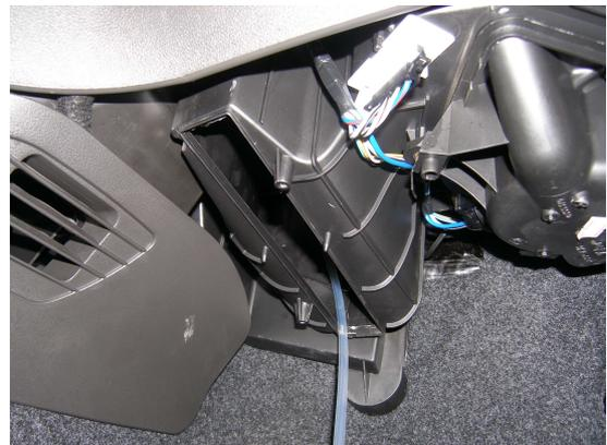
7. Durch Betätigen der Reinigungs-Pistole sowie vorsichtiges hin und her Bewegen der Sprühsonde wird der Verdampfer mit LIQUI MOLY Klima-Anlagen-Reiniger gründlich ausgespült und gereinigt. Zum Schluß je einen Sprühstoß in die Lüftungsdüsen im Innenraum geben.
