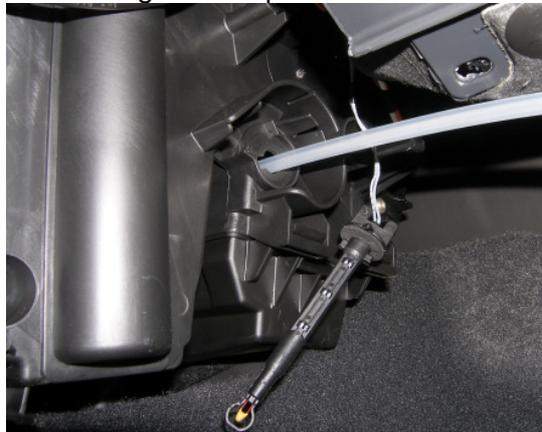
7. Durch Betätigen der Reinigungs-Pistole sowie vorsichtiges hin und her Bewegen der Sprühsonde wird der Verdampfer mit LIQUI MOLY Klima-Anlagen-Reiniger gründlich ausgespült und gereinigt. Zum Schluß je einen Sprühstoß in die Lüftungsdüsen im Innenraum geben.
