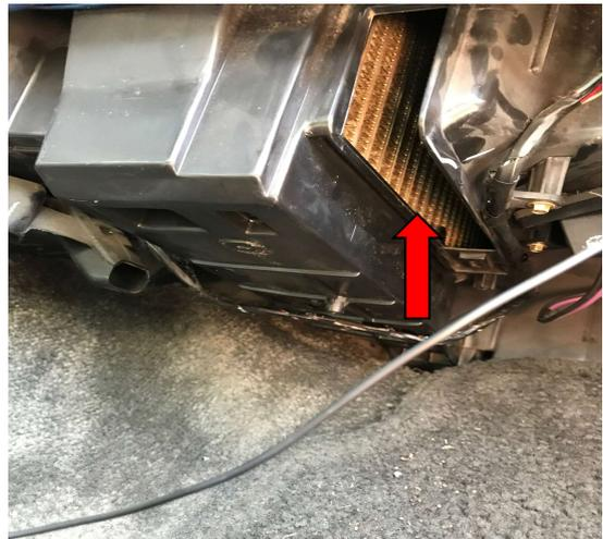
6. Durch Betätigen der Reinigungs-Pistole sowie vorsichtiges hin und her Bewegen der Sprühsonde wird der Verdampfer mit LIQUI MOLY Klima-Anlagen-Reiniger gründlich ausgespült und gereinigt. Zum Schluss je einen kurzen! Sprühstoß in die Lüftungsdüsen im Armaturenbrett geben.
