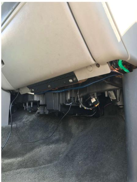
5. Sonde der Reinigungs-Pistole vorsichtig Richtung Verdampfer führen. Liqui Moly Klima-Anlagen-Reinigungs-Pistole mit 1 Liter Klima- Anlagen-Reiniger befüllen und bei 6-8 bar Druck an das Druckluftnetz anschließen. **Den Innenraumteppich durch geeignete Maßnahmen vor ablaufender Flüssigkeit schützen.**
