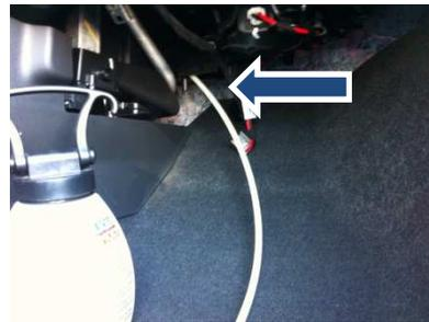
7. Durch Betätigen der Reinigungs-Pistole sowie vorsichtiges hin und her Bewegen der Sprühsonde wird der Verdampfer mit LIQUI MOLY Klima-Anlagen-Reiniger gründlich ausgespült und gereinigt. Zum Schluss je einen Sprühstoß in die Lüftungsdüsen im Innenraum geben.
