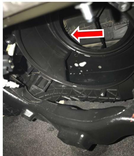
5. Sonde der Reinigungs-Pistole vorsichtig in Richtung Verdampfer einführen. Liqui Moly Klima-Anlagen-Reinigungs-Pistole mit 1 Liter Liqui Moly Klima- Anlagen-Reiniger befüllen und bei 6-8 bar Druck an das Druckluftnetz anschließen.
