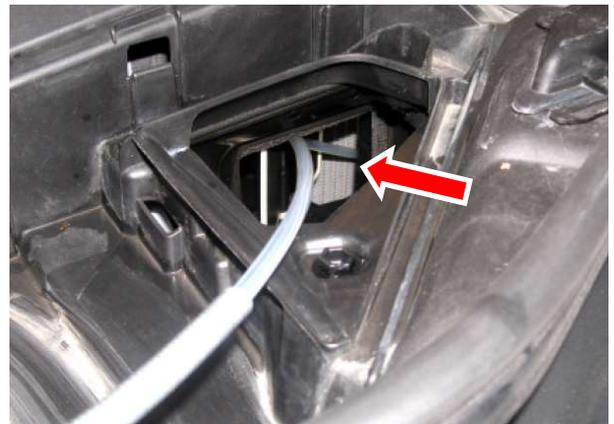
6. Durch Betätigen der Reinigungs-Pistole sowie vorsichtiges hin und her Bewegen der Sprühsonde wird der Verdampfer mit LIQUI MOLY Klima-Anlagen-Reiniger gründlich ausgespült und gereinigt. Zum Schluss je einen kurzen! Sprühstoß in die Lüftungsdüsen im Armaturenbrett geben.
