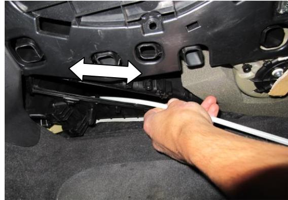
7. Durch Betätigen der Reinigungs-Pistole sowie vorsichtiges hin und her Bewegen der Sprühsonde wird der Verdampfer mit LIQUI MOLY Klima-Anlagen-Reiniger gründlich ausgespült und gereinigt.
