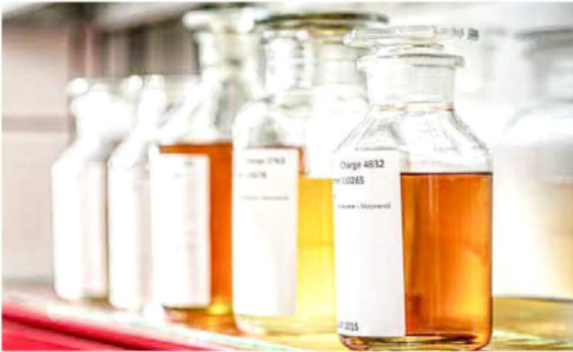
Um die Eigenschaften des Motoröls zu optimieren, werden Additivpaket, Viskositätsindex-Verbesserer und Fließverbesserer dem Grundöl beigemischt
