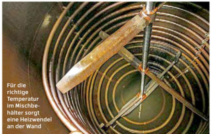
Für die richtige Temperatur im Mischbehälter sorgt eine Heizwendel an der Wand
