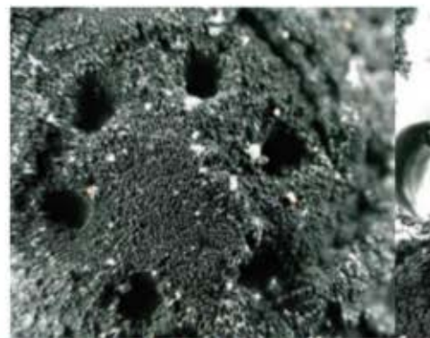
Rußablagerungen an der Einspritzdüse eines Motors.
