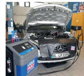
Geartonic – urządzenie do dynamicznej wymiany oleju w automatycznej skrzyni biegów. Prawdą jest, że w tym aspekcie produkcja oleju i dostawy tego typu urządzeń muszą zmierzyć się z kolejnymi mitami, że oleju w skrzyni wymieniać... nie należy.
