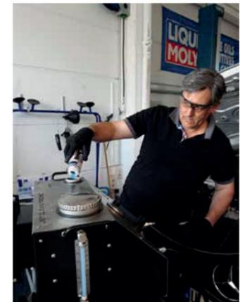
Jet Clean Tronic II tillater rengjøring av motorer i silniker benzynowych i diesla. Ten zabieg, wykonywany metodą tradycyjną, jest w nowoczesnych silnikach niezwykle trudny
