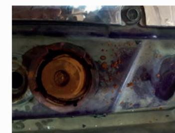
Korrosionsablagerungen im Ausgleichsbehälter und im Verschluss.
