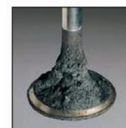
Ohne Marine Benzin-System-Reiniger: Ablagerungen an Ventilen, geringe Motorleistung.
