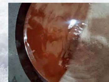
Korrosionsablagerungen in der Kühlflüssigkeit. Derartige Verunreinigungen erbringen den Nachweis dafür, dass das komplette Kühlsystem von Korrosion befallen ist.
