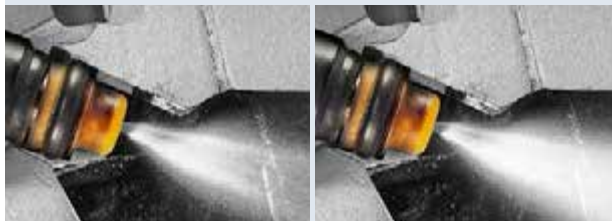
Die gereinigten Injektoren zerstäuben den Kraftstoff feiner, was zu einer verbesserten Verbrennung führt
