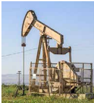
Wenn der Lagerstättendruck nachlässt, saugen Tiefenpumpen das in Gesteinsschichten schlummernde Erdöl nach oben
