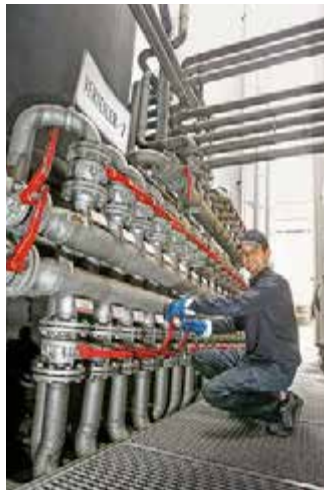
Die Verteilerstation versorgt die Mischbehälter, in denen alle Zutaten zusammenkommen
