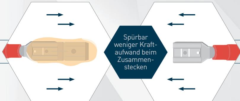
**5** Kontaktschmierstoffe füllen Unebenheiten der Kontaktoberflächen auf und schützen so vor Oxidation und Alterung. An den Kontaktspitzen wird der Schmierstoff verdrängt und somit ermöglicht, dass Strom fließen kann. Dadurch wird auch Passungsrost verhindert.
