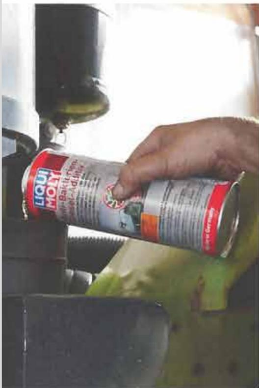
Vorbeugen ist besser als reinigen. Mit der regelmäßigen prophylaktischen Beigabe von speziellen Kraftstoffzusätzen wie dem ‚Anti-Bakterien-Diesel-Additiv‘ von Liqui Moly lässt sich schädliches Mikrobenwachstum vermeiden. Davon sind längst nicht nur saisonal benutzte Nutzfahrzeuge oder Wohnmobile mit längeren Standzeiten betroffen. Bild: Kuss
