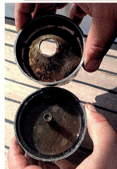
Wenn das Kraftstoff-System erstmal mit der sog. „Dieselpest“ befallen ist, ist oft eine Tankeinigung unumgänglich. Additive sollen vorbeugen und auch bei einer Akut-Anwendung eine „heilende“ Wirkung haben.
